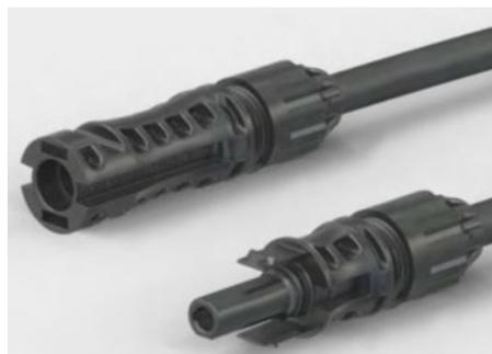
Pour raccorder les modules, des câbles solaires spéciaux d'un diamètre minimum de 4 mm<sup>2</sup> doivent être utilisés. Seuls des connecteurs identiques (même marque et même modèle) doivent être utilisés. Nous recommandons donc l'utilisation des connecteurs Stäubli Electrical de type EVO2 qui sont ceux présents sur les panneaux. Ces câbles doivent être résistants aux UV et à l'usure. Eviter de laisser les câbles exposés aux éléments ou les placer dans une gaine protectrice.
